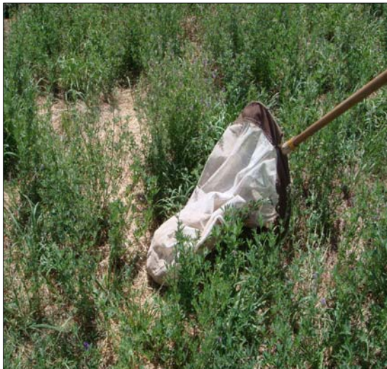
Fig.2: Detalles de la red entomológica: aro de acero 5,5mm, diámetro del aro 42cm, profundidad 75cm, mango 1,20m.
